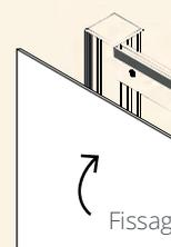
Per la grafica in PVC utilizzare un supporto 550 micron. Applicare il nastro magnetico incluso nella versione standard (EM301) alla struttura e sul retro della stampa. Infine, posizionare il media sulla struttura.
